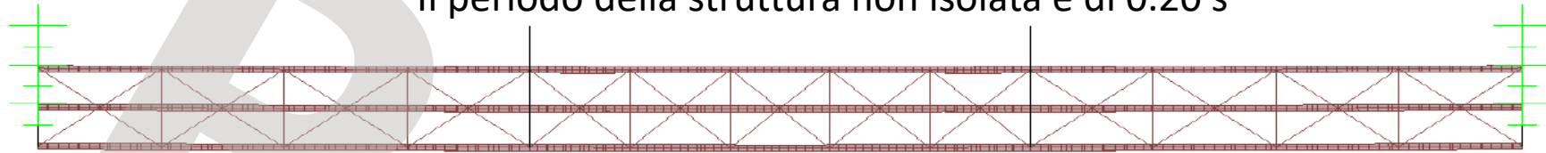
Figura 6.2 1° modo di vibrare traslazionale trasversale - T=1.95 sec
