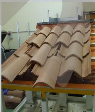
1. Stato Limite di Danno (SLD): il manto di copertura non garantisce impermeabilità agli strati inferiori del manto di copertura, alla struttura in elevazione, ad oggetti e persone che ne usufruiscono.
