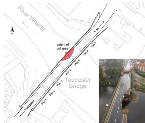
Figura 7-1 – Schema del Tadcaster Bridge, in Inghilterra, che mostra la posizione del ponte e l'entità del crollo. Foto del luogo del crollo scattata dopo l'inondazione (Selvakumaran et al., 2018).
