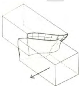
Figura 5-16 – Confronto tra la distribuzione delle lesioni (a) in un muro solido e (b) in un muro con aperture, dovuta a movimenti differenziali orizzontali nel piano nella parte terminale di un muro o in un angolo (figure adattate da Mastrodicasa, 1943).
