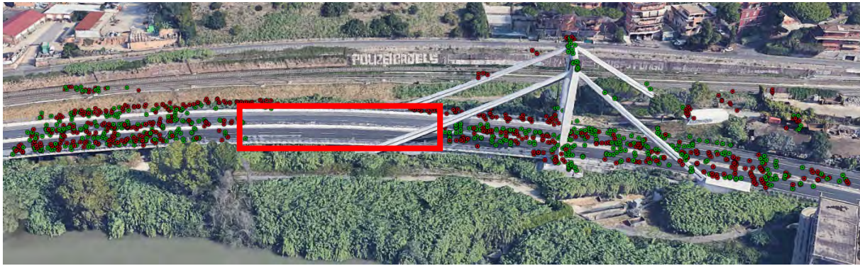
Figura 2-21 - Esempio di distribuzione spaziale dei punti di misura ottenuti dall'elaborazione interferometrica multi-temporale SBAS-DInSAR a piena risoluzione spaziale di due dataset ascendenti (punti di misura rossi) e discendenti (punti di misura verdi) in un'area a Sud-Ovest di Roma. Il rettangolo rosso identifica un'area dove non sono stati rilevati punti di misura.
