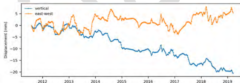
Figura 10-55 – Serie di spostamenti verticale e orizzontale E-W di un punto nella zona sud-ovest del complesso del S. Michele (evidenziata da un cerchio giallo in Figura 10-54).
