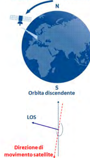
Figura 2-2 – Schema di acquisizione di immagini satellitari da orbite ascendenti e discendenti.
