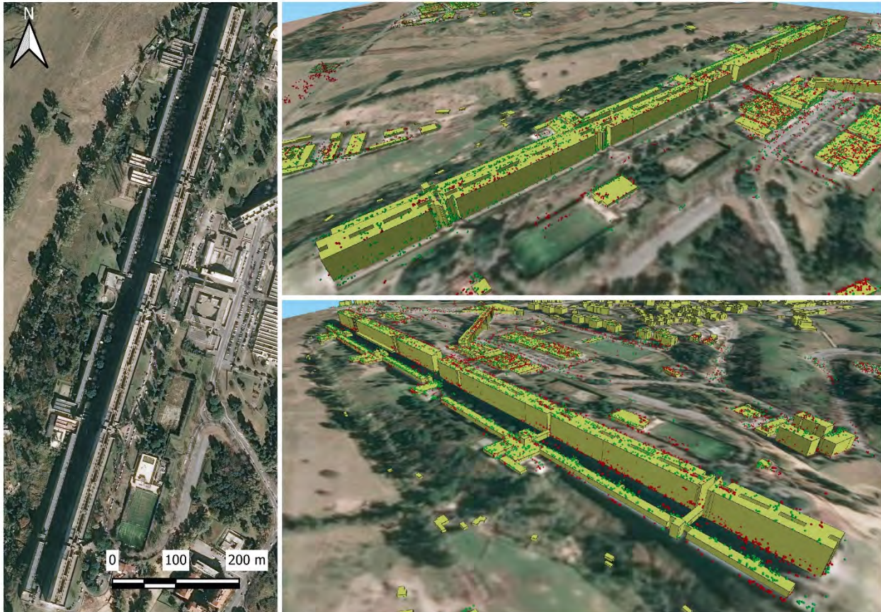
Figura 3-5 – Distribuzione dei punti di misura del dataset ascendente (rosso) e discendente (verde) per l'edificio del Corviale in Roma.
