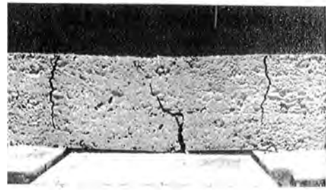
Figura 5-15 – Cedimento verticale localizzato nella parte centrale di un elemento murario: (a) schema di formazione dell'arco di scarico; (b) lesioni a flessione (figure tratte da Mastrodicasa, 1943).
