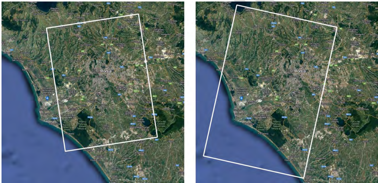
Figura 12-1 – Copertura al suolo dei dati CSK acquisiti da orbite ascendenti (a) e discendenti (b) relativi all'area di Roma, scelta come area di riferimento in queste linee guida.
