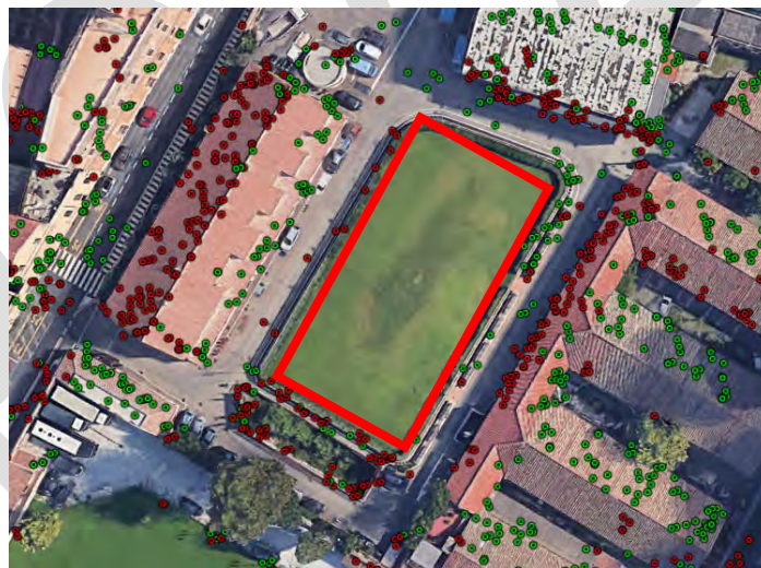
Figura 2-20 – Esempio di distribuzione spaziale dei punti di misura ottenuti dall'elaborazione interferometrica multi-temporale SBAS-DInSAR a piena risoluzione spaziale di due dataset ascendenti (punti di misura rossi) e discendenti (punti di misura verdi) in un'area del centro storico di Roma. Il rettangolo rosso identifica un'area dove non sono stati rilevati punti di misura.
