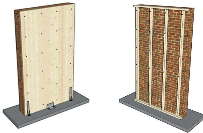
Figura 166: Tipologie considerate per il rinforzo fuori-piano dei pannelli murari [43]
