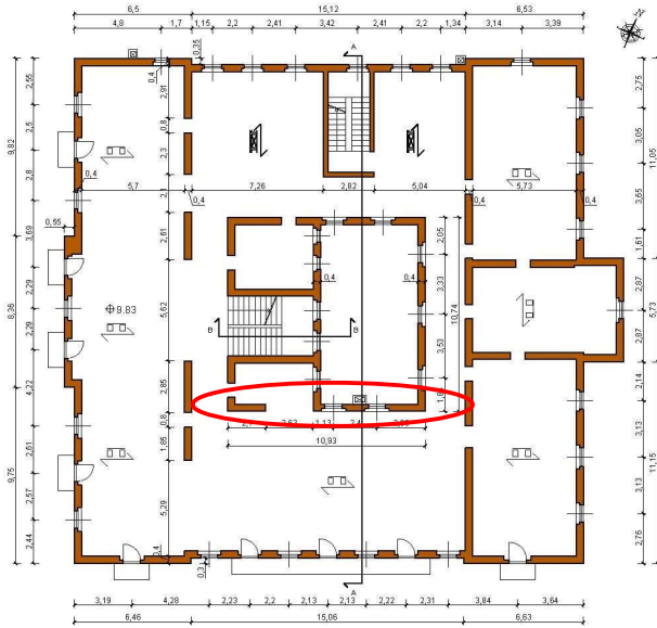
a) Parete più danneggiata
