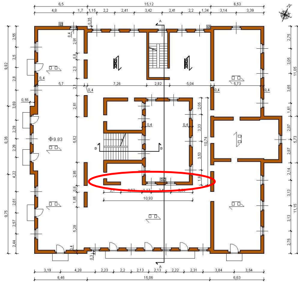
a) Individuazione della parete maggiormente danneggiata
