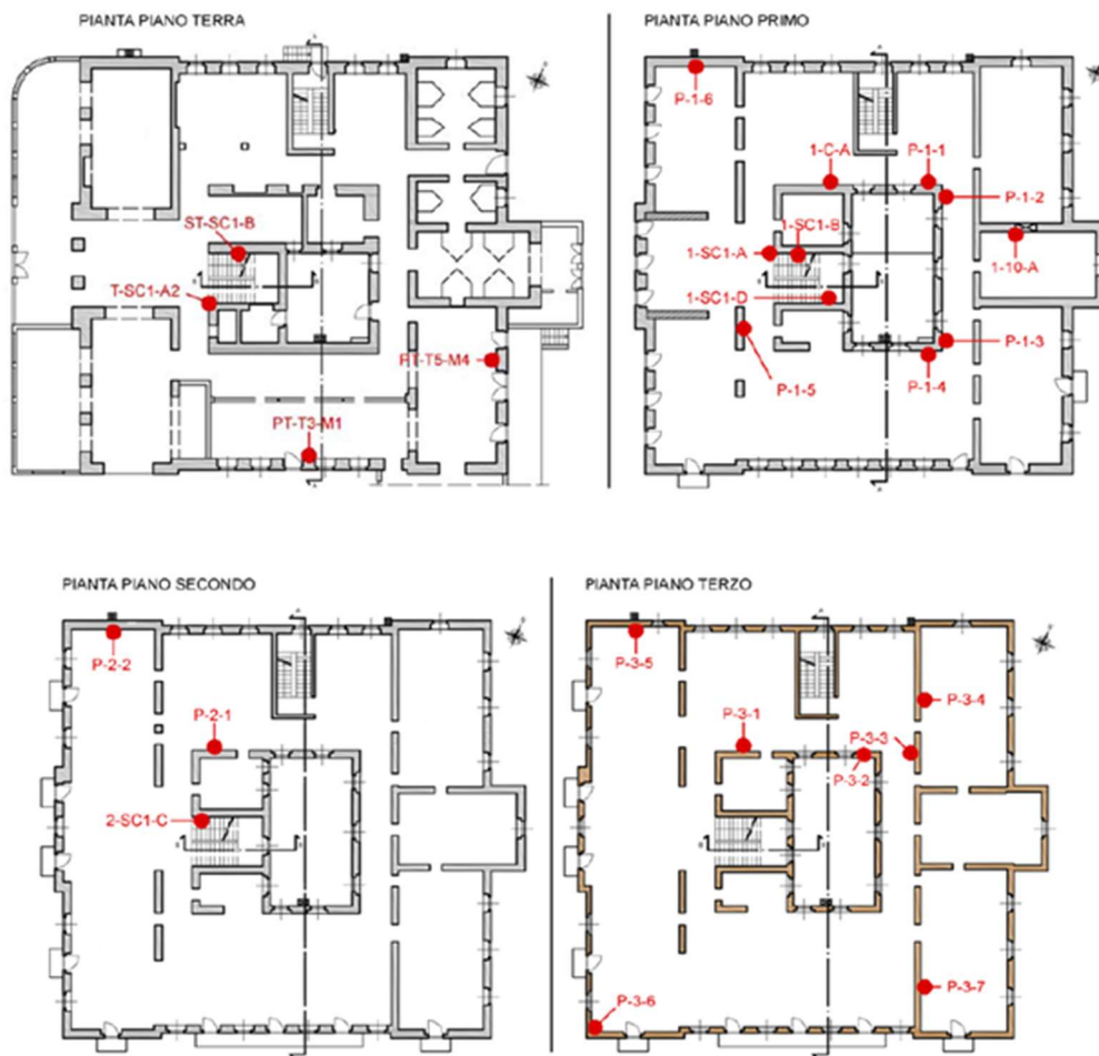
Figura 45: Localizzazione dei punti di estrazione dei campioni di malta e nomenclatura adottata
