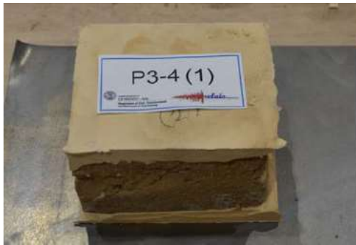
Figura 49: Campione pronto per la prova di compressione
