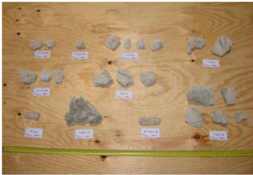
Figura 43: Campioni irregolari estratti dalla muratura
