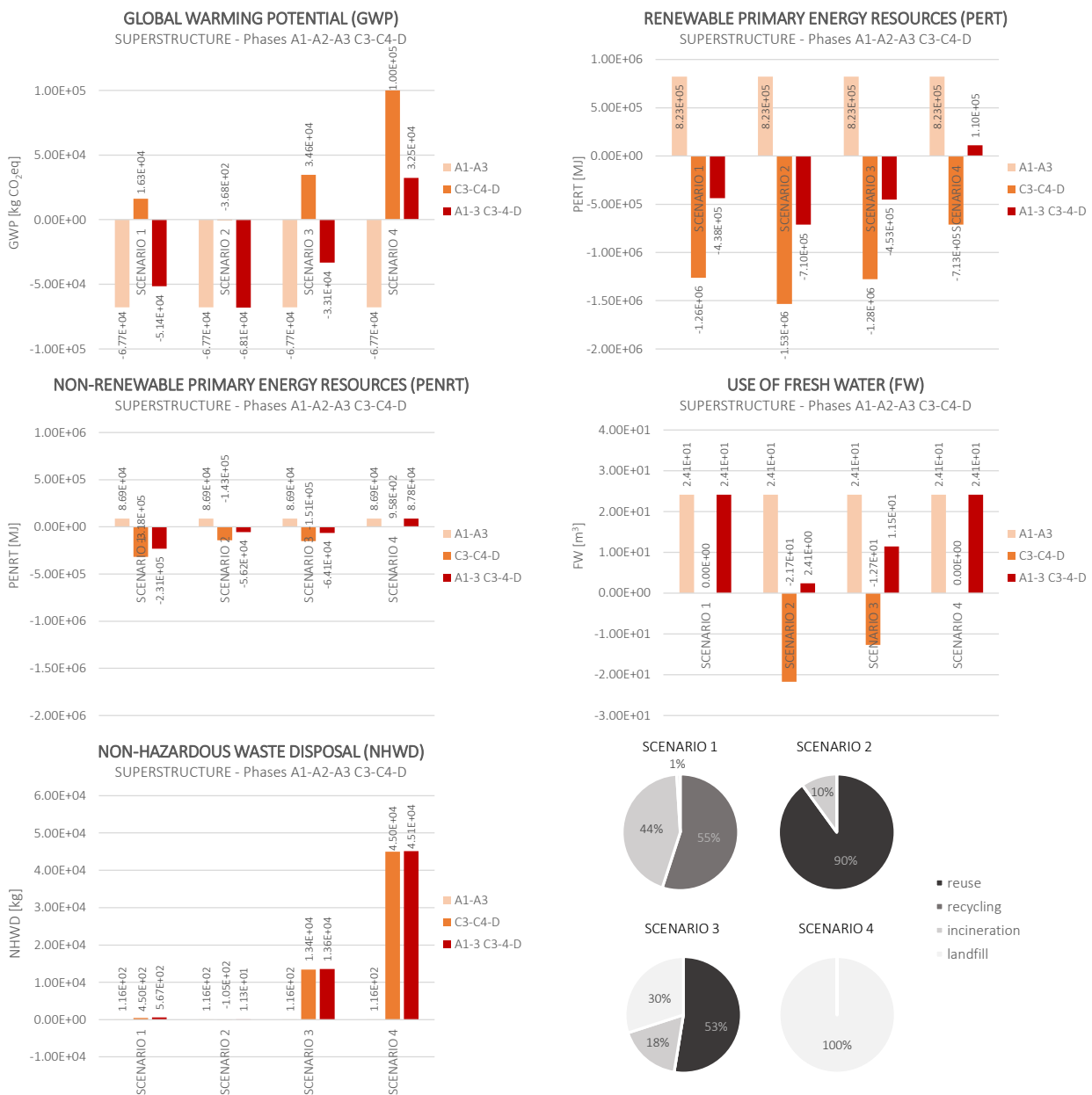
Figura 38 - Analisi di diversi scenari di fine vita per i pannelli XLAM della sovrastruttura.
