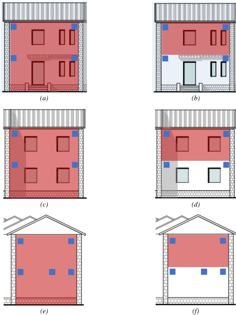
Figura 4-12: Macroblocchi verificati mediante analisi cinematica con l'inserimento di catene (i cui ancoraggi sono identificati in blu): prospetto sud a) cinematismo A, intera parete e b) cinematismo B, piano primo; prospetto nord c) cinematismo C, intera parete e d) cinematismo D, piano primo; prospetto ovest e) cinematismo E, intera parete e f) cinematismo F, piano primo.
